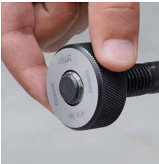
Prüfung mit Präzisions-Gewindelehring Checking with Precision Thread Ring Gauge
