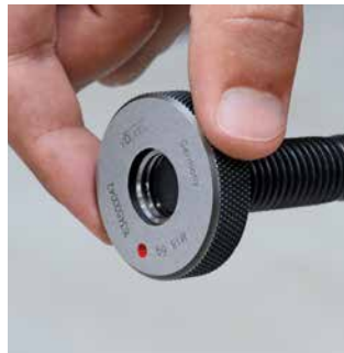
Prüfung mit Präzisions-Gewindelehring Checking with Precision Thread Ring Gauge
